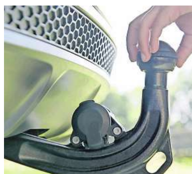
Haken mit Köpfchen: Die Firma Westfalia erfand 1932 die heute bekannte Anhängerkupplung mit Kugelkopf.
